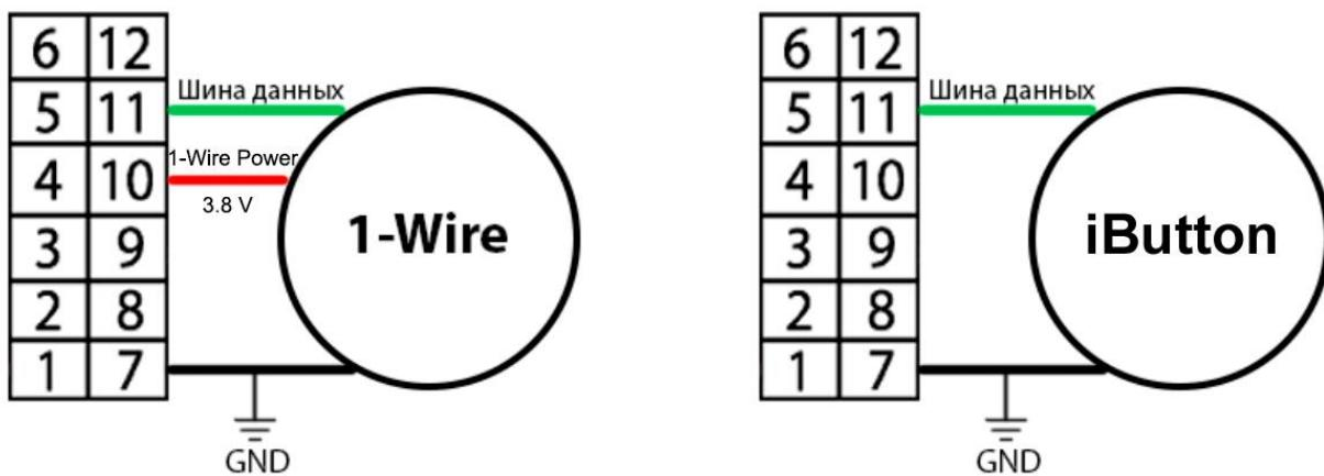
В случае если устройству, подключаемому через цифровой интерфейс 1-Wire, требуется напряжение более 3.8 V, подключите положительный контакт к внешнему источнику питания, например, к автомобильному аккумулятору.
